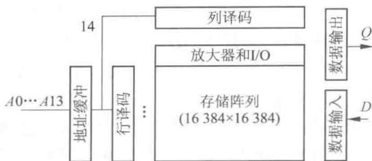
图 5.19 256M 位 DRAM 的内部结构
