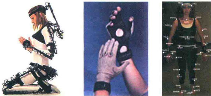
图 9.9 主动式运动捕捉的三种方式:电子机械式、光纤式、闪光标记式
