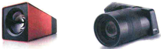
图 8.4 第一代和第二代光场相机
