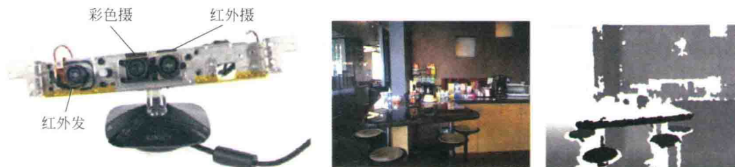
图 3.21 Kinect 设备及拍摄的彩色和深度图像(图片来自[14])
