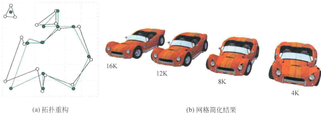
图 4.10 基于顶点聚类的网格简化
