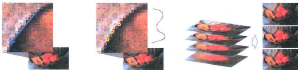
(a) Sobel 算子定义的笔画方向 (b) B 样条曲线定义的笔画形状 (c) 笔画逐层覆盖
