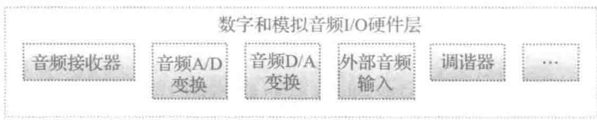
c) MHP音频I/O设备驱动程序示例 [33]
