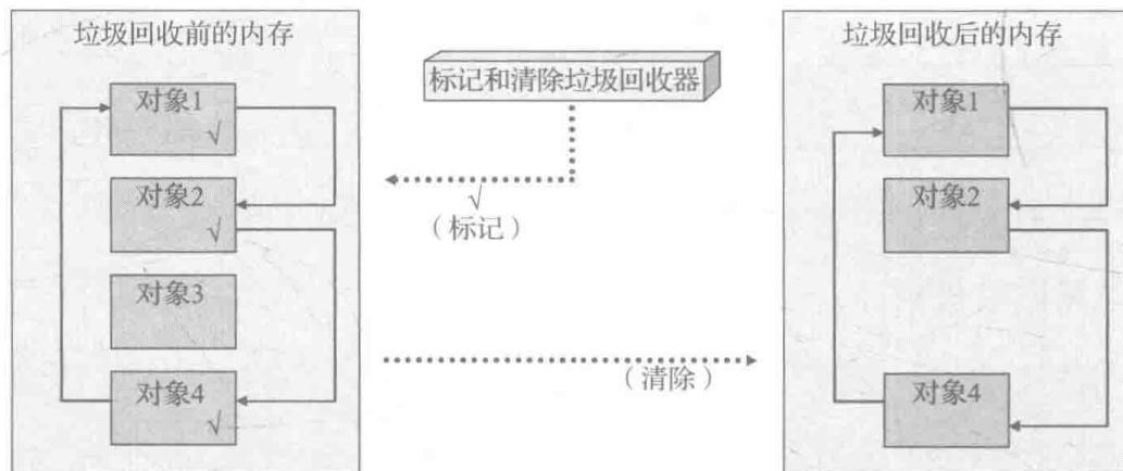
图 2-14 标记和清除（无压缩）垃圾回收机制
