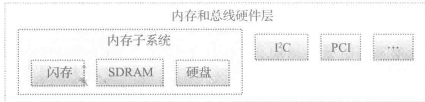
图 2-47 MHP 平台上内存和总线设备驱动程序示例 [33]
