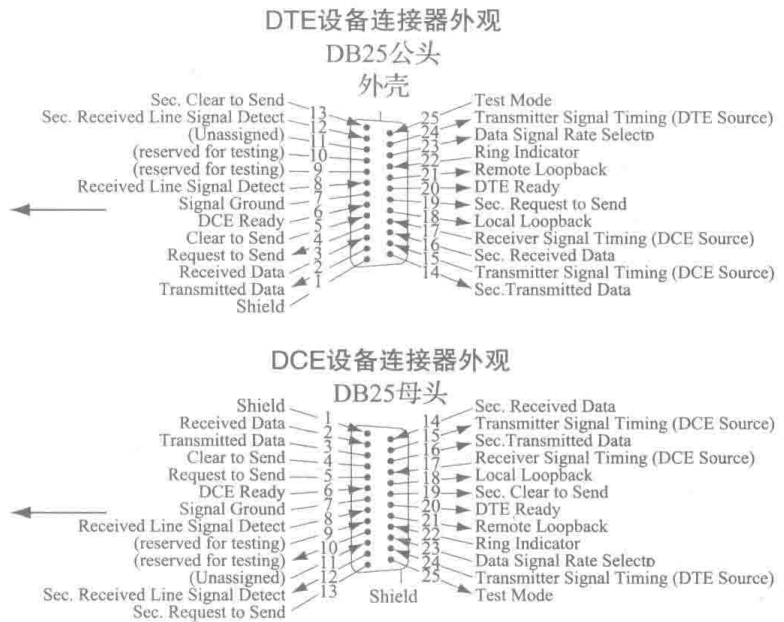
a) RS-232 信号和 DB25 连接器
