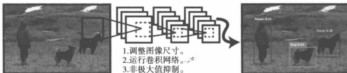
图 6-26 YOLO 的工作流程
