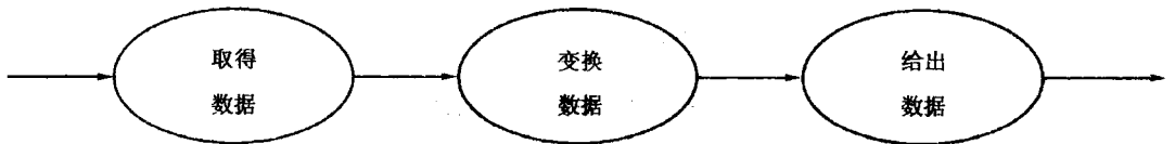
图 4.9 变换型数据流图所表示的数据处理模式
